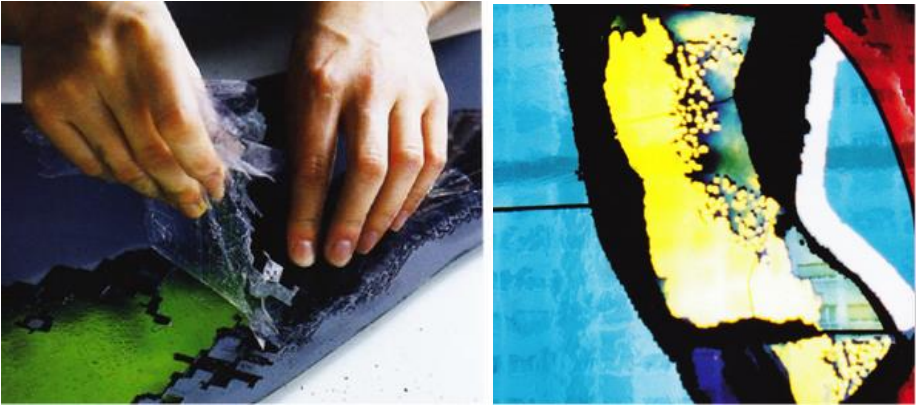
FIG. 4 ET 5 : ENLÈVEMENT DES ADHÉSIFS PROTÉGANT LE VERRE APRÈS MORSURE À L'ACIDE FLUORHYDRIQUE © ATELIERS FLEURY
